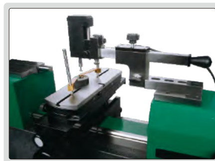
измерение резьбового кольцевого калибра
