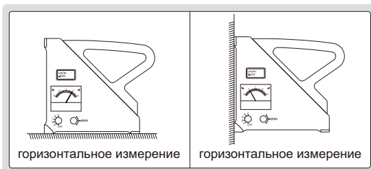
измерение плоскостности поверхности
