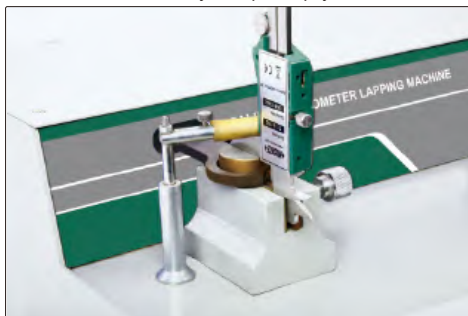
притирка измерительных поверхностей нижних губок кронциркуля
