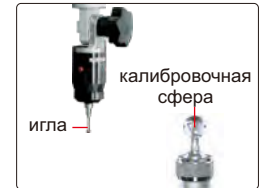
датчик (опция), включает в себя иглы Ø2 мм и Ø3 мм, калибровочная сфера Ø25 мм, точность измерения 10 мкм
