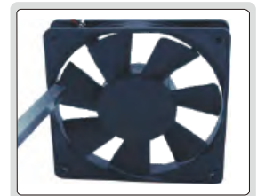
измерение зазора между лезвием и боковиной
