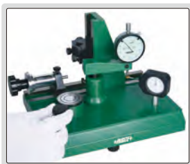
проверка усилия циферблатных индикаторов
