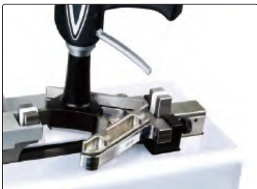
установка нуля и калибровка трехточечных внутренних микрометров
