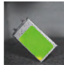
испытание батарейного блока на падении изображение поля деформации
