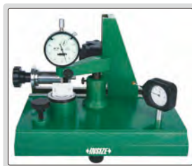
проверка воспроизводимости циферблатных индикаторов
