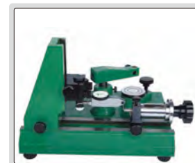
проверка точности контрольных индикаторов
