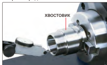
измерение радиального биения хвостовика
