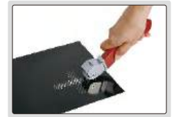
шаг 1: создание сетки надрезов на поверхности
