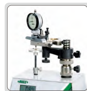
проверка силы измерения глубиномера
