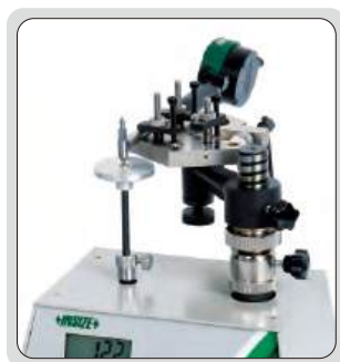
проверка измерительного усилия нутромера
