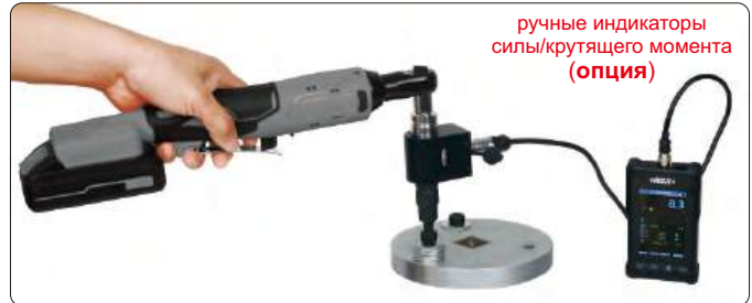
пример проверки крутящего момента
