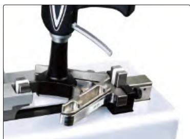
установка нуля и калибровка трехточечных внутренних микрометров
