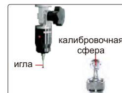
датчик (опция), включает в себя иглы Ø2 мм и Ø3 мм, калибровочную сферу Ø25 мм, точность измерения 10 мкм
