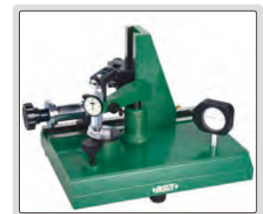
проверка влияния боковой силы на точность контрольных индикаторов (требуется полукруглый измерительный блок)
