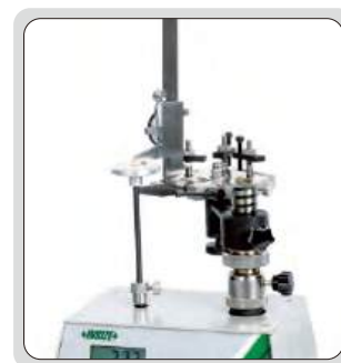
проверка измерительного усилия штангенциркуля
