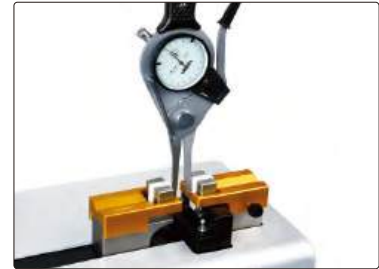
установка нуля и калибровка внутренних/внешних манометров с защелкой
