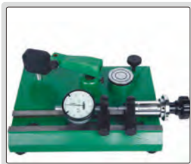
проверка точности циферблатных индикаторов (диапазон 0-25 мм)
