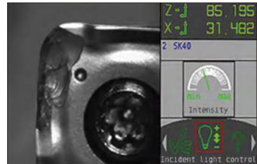
проверка износа режущей кромки
