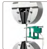
высокоточный осевой экстензометр (опция, можно выбрать различные шкалы, чтобы полностью удовлетворить требованиям различных материалов, точность соответствует классу 0.5)
