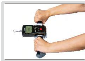
тест на вытягивание с двумя руками
