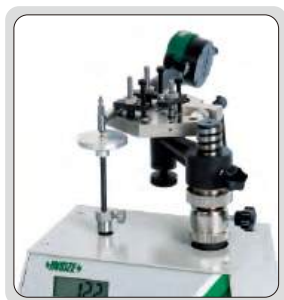
проверка измерительного усилия нутромера
