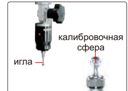
датчик (опция), включает в себя иглы \varnothing 2 мм и \varnothing 3 мм, калибровочную сферу \varnothing 25 мм, точность измерения 10 мкм
