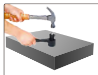
удар молотком для приложения испытательного усилия
