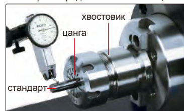
измерение радиального биения цанг
