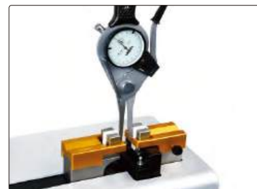
установка нуля и калибровка внутренних/внешних манометров с защелкой
