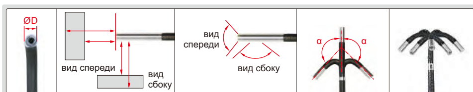
диаметр (ØD) глубина поля (DOF) угол зрения ( \theta ) диапазон изгиба ( \alpha ) сгибается в 4-х направлениях
