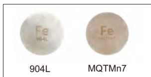
калибровочные фольги на железной основе (в комплекте)
