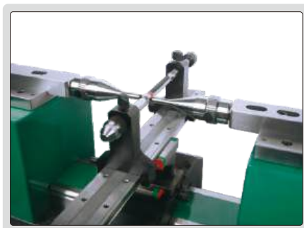
измерение калибра плунжера
