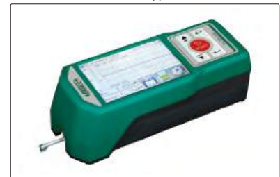
датчик и основной блок могут быть объединены
