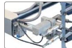
шириномер (опция, широко используется для определения значения и измерения коэффициента Пуассона, соответствует требованиям ASTM E517 и ISO10113)
