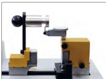
установка нуля и калибровка циферблатного компаратора
