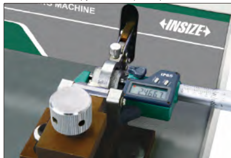
притирка измерительных поверхностей наружного микрометра
