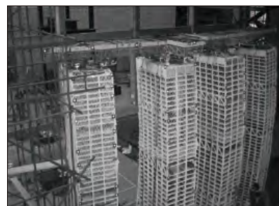
мониторинг деформации вибрационные испытания больших зданий
