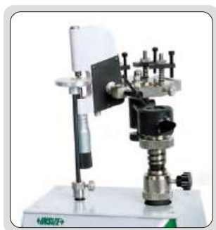
проверка измерительного усилия микрометра
