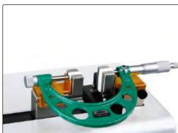
установка нуля и калибровка микрометров
